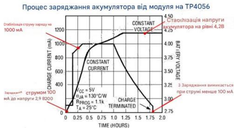
Рис. 2.16. Процес зарядки акумулятора на TR4056
